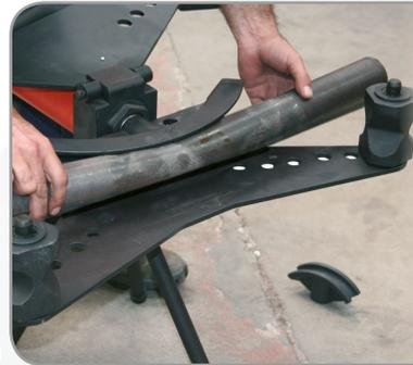
**1.** Especialmente diseñado para curvar tubos de acero DIN 2440 y API para conducción de agua, combustible, etc. con el máximo confort y velocidad.
